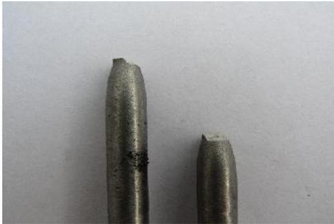
**Gambar 12** – Contoh Patahan Benda Uji dengan Posisi *Dial* 0,2.
